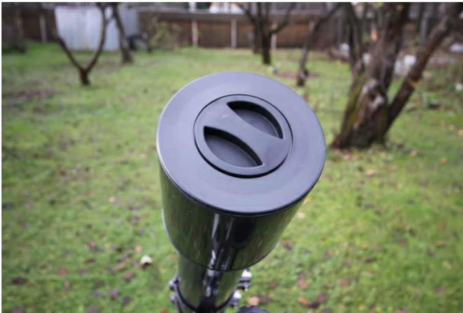
Защищающая оптику телескопа от росы и паразитных боковых лучей пластиковая бленда – съемная.
